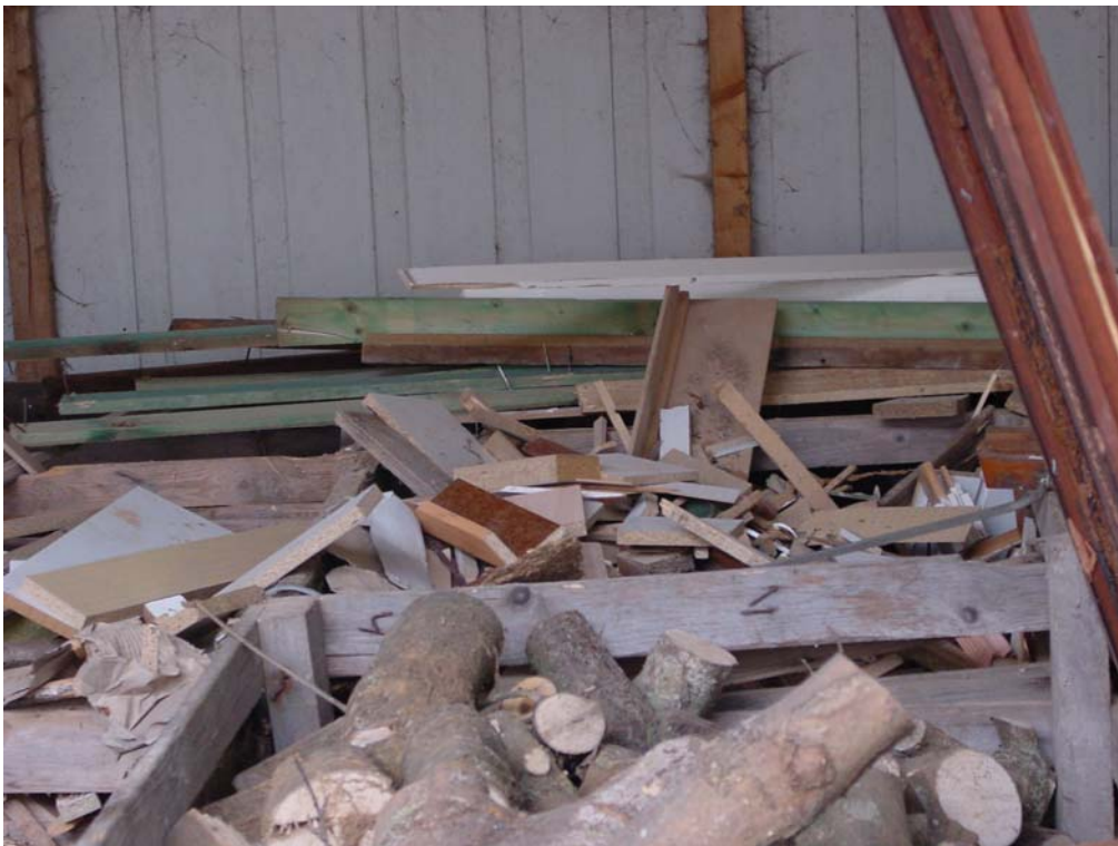
Abb. 2: Imprägnierte Dachlatten und Holz aus Abbruch, die für die Verbrennung in Holzfeuerungen nach 1. BImSchV nicht zulässig sind, lagern zusammen mit aufbereiteten Holzbrennstoffen. Foto: LLUR
