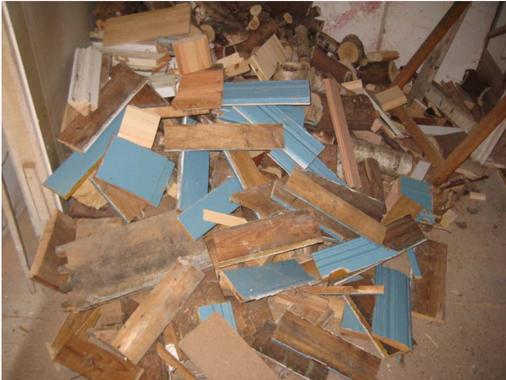
Abb. 1: gestrichenes Holz (blaue Farbe) und Fensterrahmen (weiße Farbe) aus Abbruch darf nicht in Feuerungen nach 1. BImSchV verbrannt werden, weil man nicht weiß, was nachträglich zum Anstrich in der Fertigung hinzugefügt wurde, und, weil gestrichene Holzreste aus der Produktion mengenmäßig eher untergeordnet sind. Foto: LLUR
