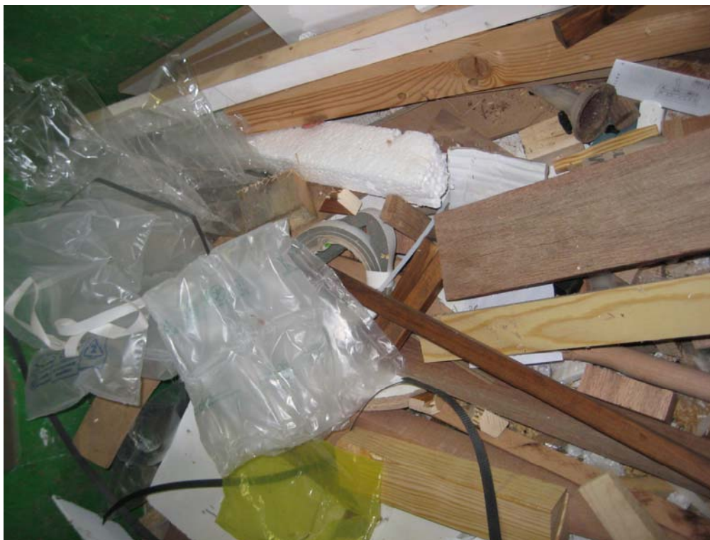
Abb. 3: Verpackungsreste aus Kunststoff, die nach 1. BImSchV nicht als Regelbrennstoff zulässig sind, lagern zusammen mit Holzresten aus der Produktion. Fotos: LLUR
