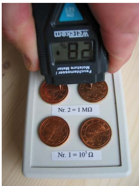
Abb. 1: Prüfgerät zur Ermittlung der Kennlinie mit definierten Ohm'schen Widerständen
