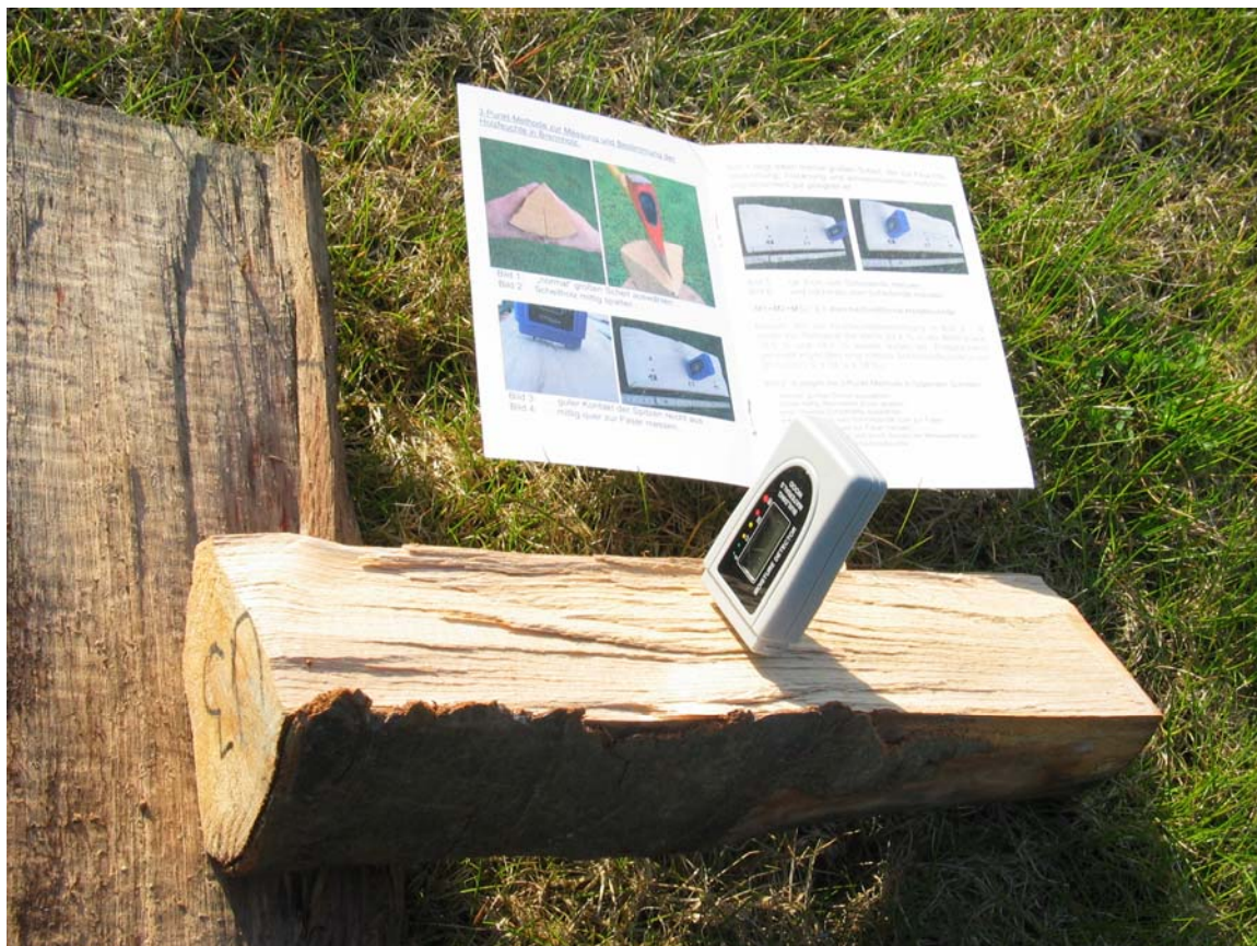
Abb. 3: Methode zur Messung und Bestimmung der Brennholzfeuchte. Quelle: Institut für Brennholztechnik, www.ibt-kraemer.de
