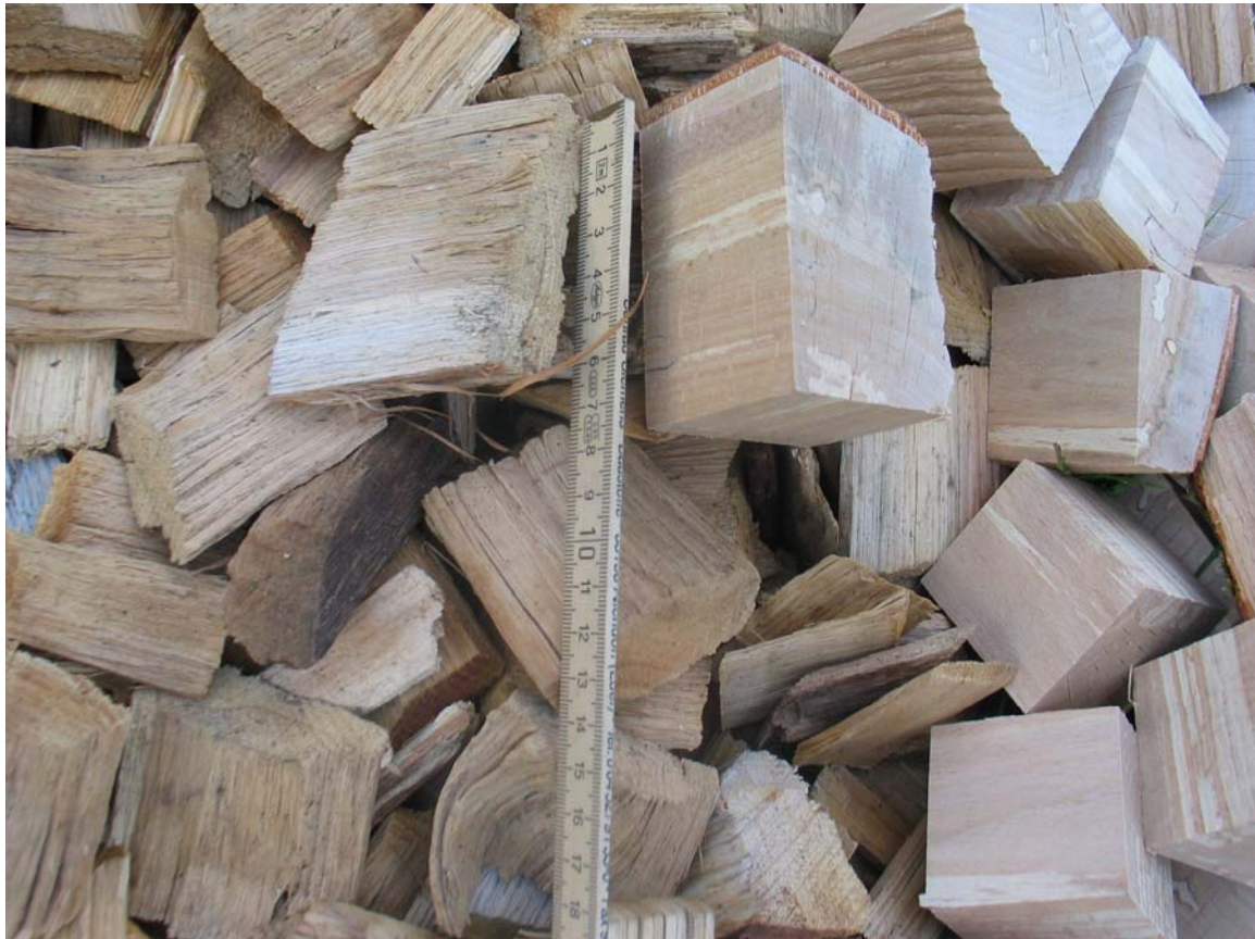
Abb. 5: links Grobhackschnitzel / rechts Würfelholz für Füllschachtkessel geeignet Quelle: Institut für Brennholztechnik
