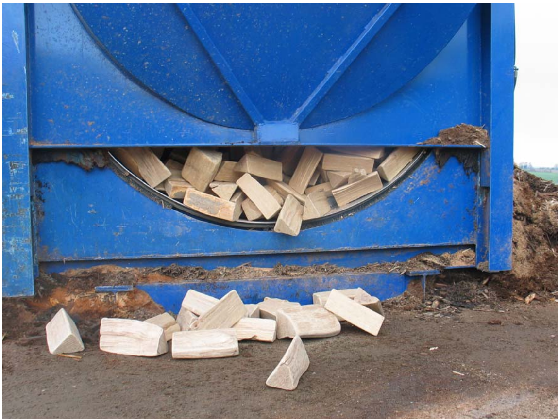
Bild 3: Trommeltrockner S+Ü wird durch einen Schieber nach oben geöffnet, Foto: KRÄMER
