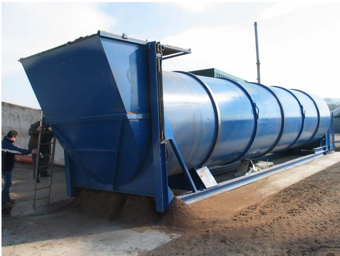
Bild 1: Trommeltrockner S+Ü, Pilotanlage Biogasanlage Marienmünster, Foto: KRÄMER
