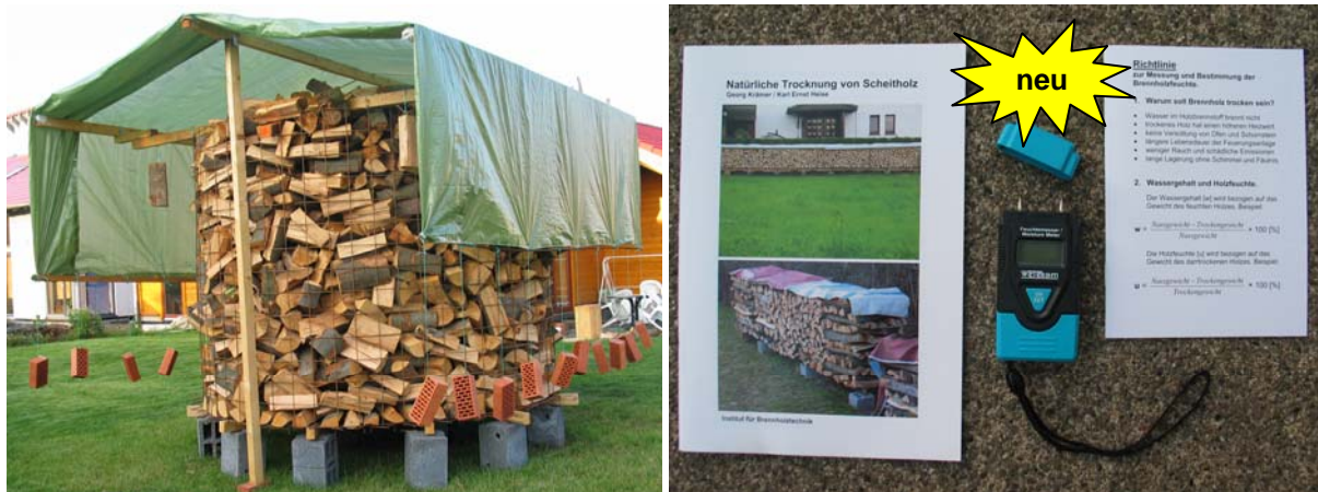
Abb. 1 und 2: Brennholz trocknet in weniger als 1 Jahr an der Luft. Die Feuchte kann mithilfe einer verständlichen Meßmethode und eines einfachen Meßgerätes festgestellt werden.
